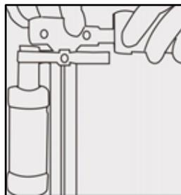
Нажмите на фиксаторы на ручках руля, вытяните их и опустите вниз, фиксируя в боковых держателях
