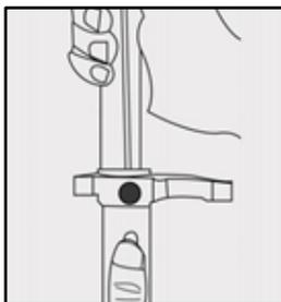
Нажмите на фиксатор и опустите руль до максимально возможного низкого положения
