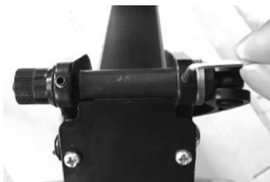
Если механизм складывания заклинило, необходимо ослабить два небольших винта, фиксирующие зажим с помощью малого шестигранного ключа. Если же рулевая стойка неустойчива, затяните эти же винты, после того, как самокат разобран, до достижения необходимого результата.
