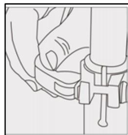
Потяните держатель руля вверх, установите необходимую высоту путем нажатия на фиксатор и зафиксируйте зажим рулевой стойки
